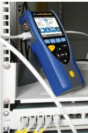
Abbildung 5: Ethernet-Inline-Tester beschleunigen die Fehlerdiagnose im Netzwerk
