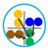
Diafonía exógena: en lugar de medir la señal acoplada de un par a otro en el mismo cable, la diafonía exógena mide la señal de un cable acoplada a un cable diferente. La diafonía exógena se hace problemática con frecuencias superiores a 300 MHz, pero se elimina casi por completo cuando se utilizan cables blindados o apantallados.
