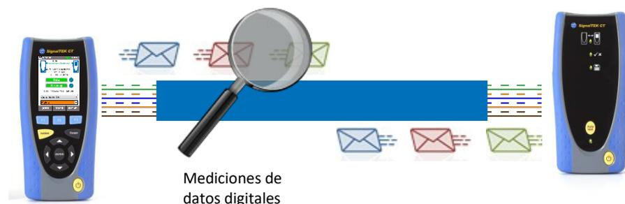
*Los comprobadores de transmisión determinan el rendimiento contando las tramas perdidas a una velocidad fija o midiendo la mayor velocidad de datos conseguida sin que se pierdan tramas.*
